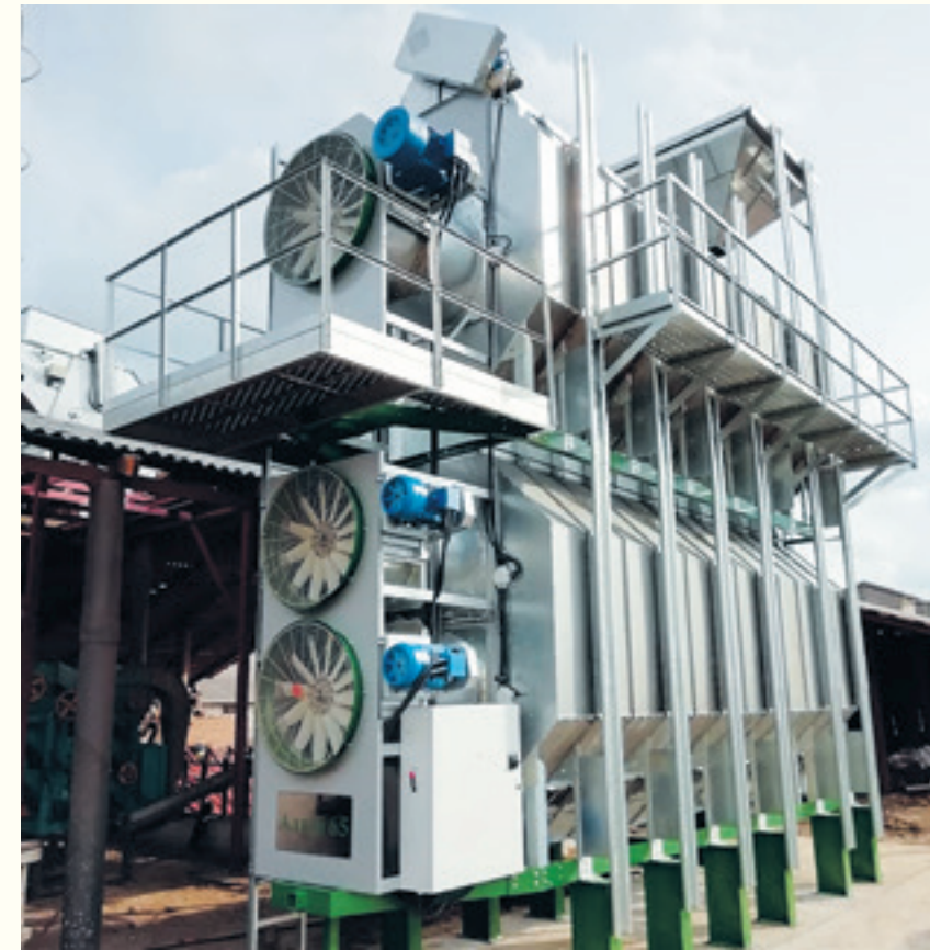
Двухмодульная: Алтай-42 (произв. — 42 т/ч) Алтай-65 (произв. — 65 т/ч)
