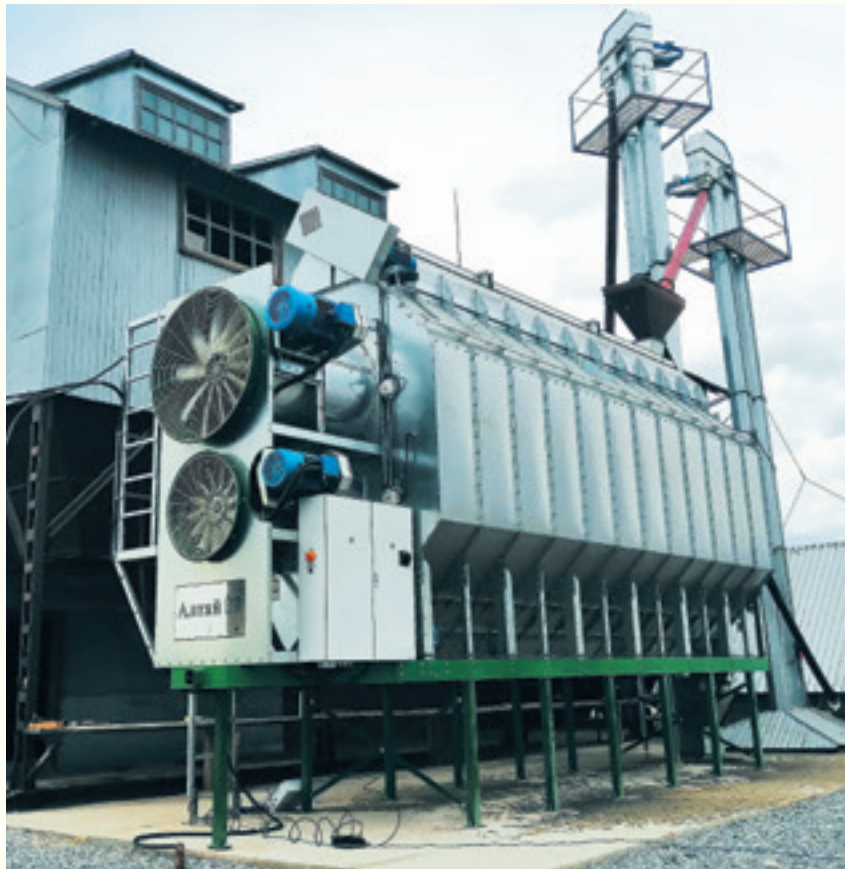
Одномодульная: Алтай-17 (произв. — 17 т/ч) Алтай-27 (произв. — 27 т/ч)
